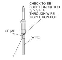
INSULATION SHOULD BUTT UP AGAINST THE END OF THE CONTACT.
